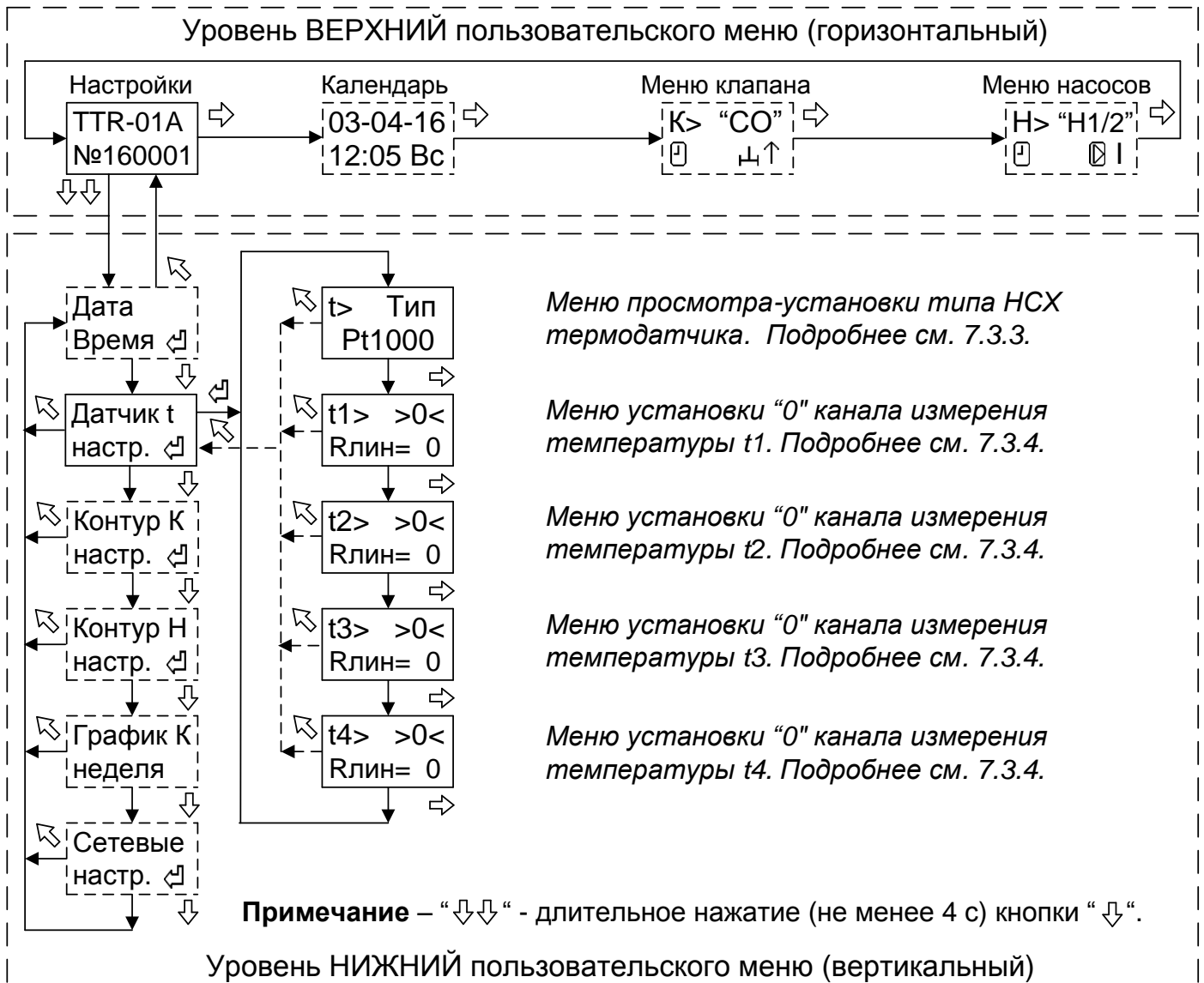
Рисунок 3 - Структура меню настройки канала измерения температуры
