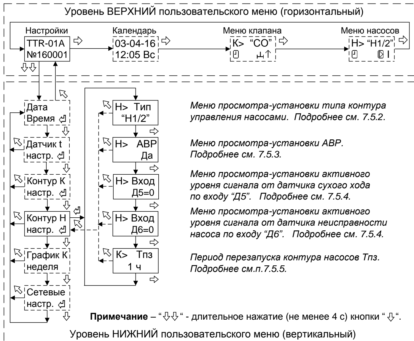
Рисунок 9 - Структура меню настройки параметров контура управления насосами.
