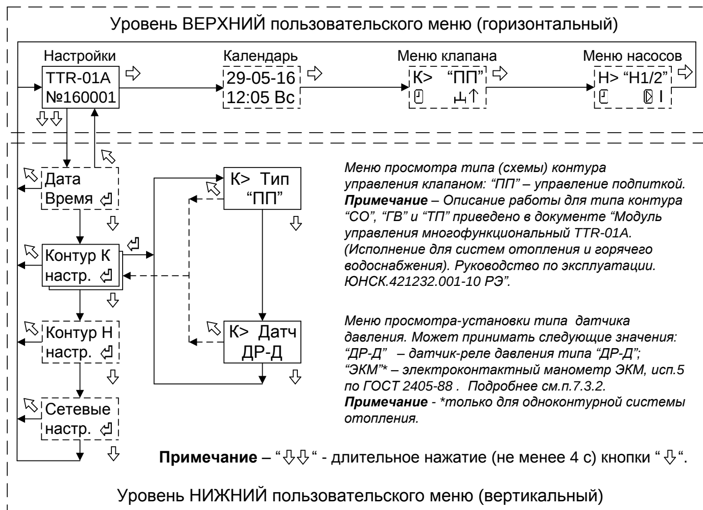
Рисунок 4 - Структура меню настройки параметров контура управления клапаном подпитки
