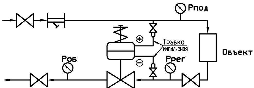
**Схема подключения регулятора давления "после себя"**
