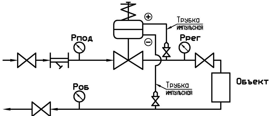
**Схема подключения регулятора перепада давления
