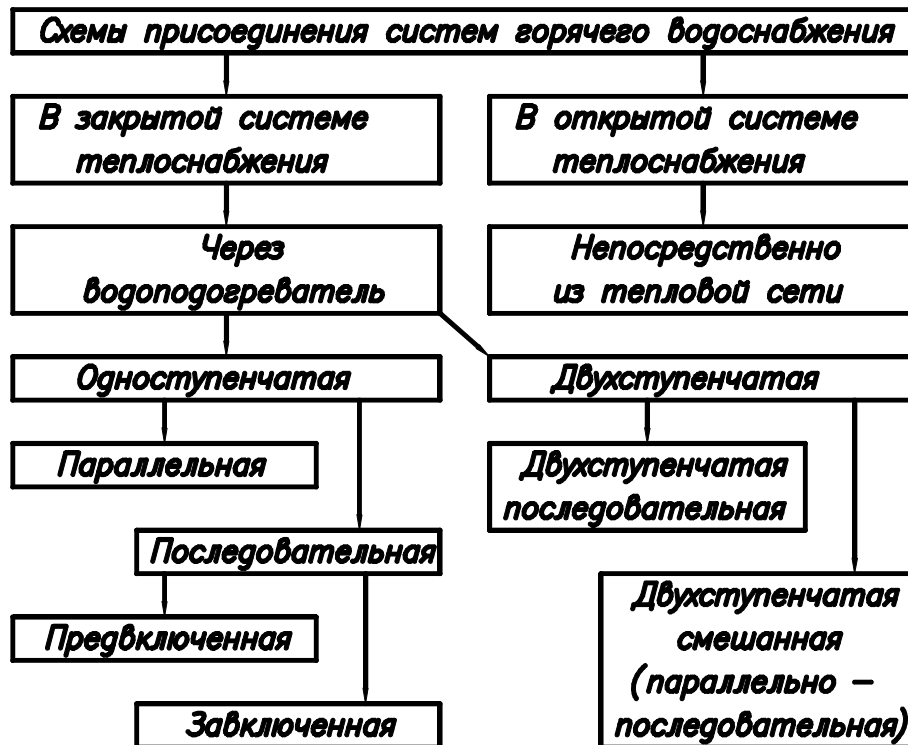
Рис. 16 Классификация схем присоединения систем горячего водоснабжения к тепловым сетям энергосистемы
