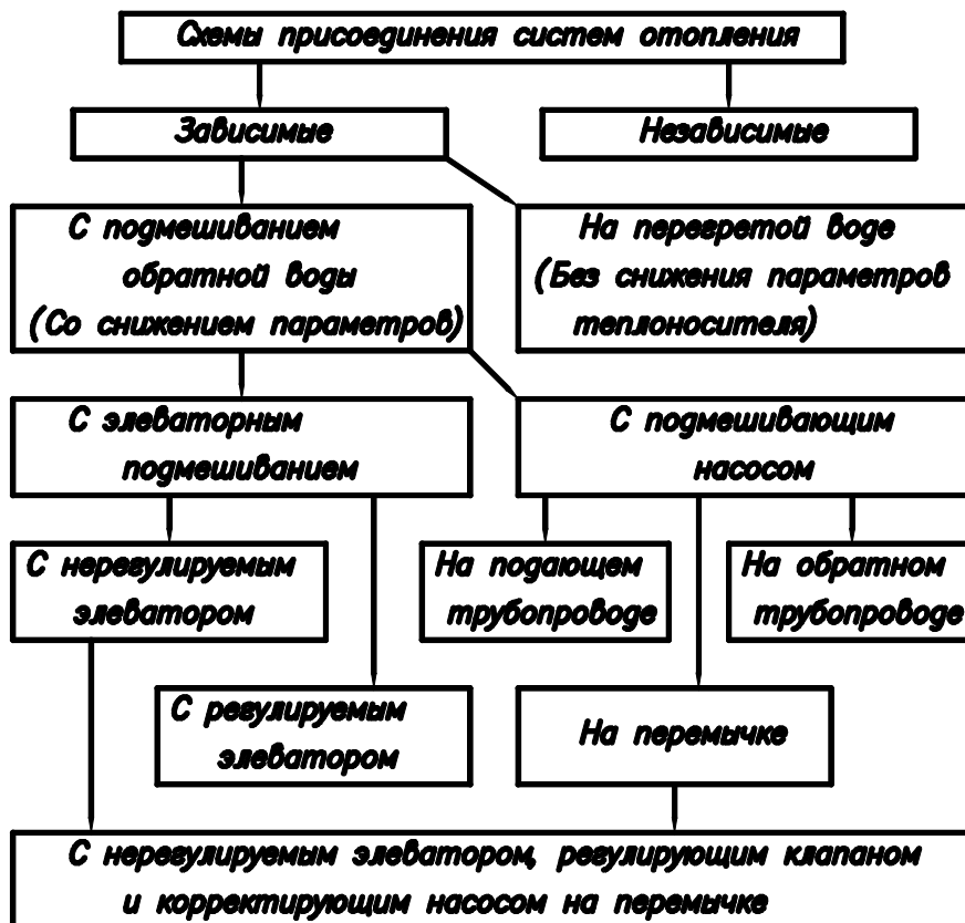
Рис. 1 Классификация схем присоединения систем отопления к тепловым сетям энергосистемы
